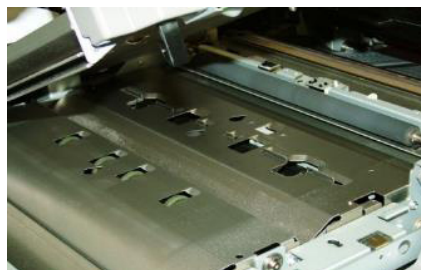
Eine Ausrichteschränke korrigiert eventuellen Schiefelauf des Papiers und wird abgesenkt, wenn der Bogen zur Feineinstellung an den Kontaktbildsensor (CLIS; Contact Image Sensor) weitergeleitet wird.
